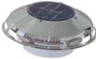
B - Aérateur solaire "jour et nuit". Fonctionnement continu grâce à une pile Ni-Cad (1,2 V - 2 A) - 19 m 3 /h. Livré avec 2 hélices, passe-pont et couvercle. Ø hors tout 230 mm.
